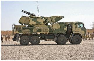
Flab-System «Pantsyr-S1, bewaffnet mit zwei Kanonen 30 mm sowie 12 abschussbereiten Boden-Luft-Lenkwaffen.
