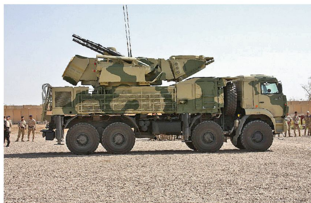
Flak-System «Pantsyr-S1, bewaffnet mit zwei Kanonen 30 mm sowie 12 abschlussbereiten Boden-Luft-Lenkwanne.
