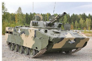
Der neue Luftlandepanzer BMD-4M mit Kanone 100 mm und 30-mm-Automatenkanone.
