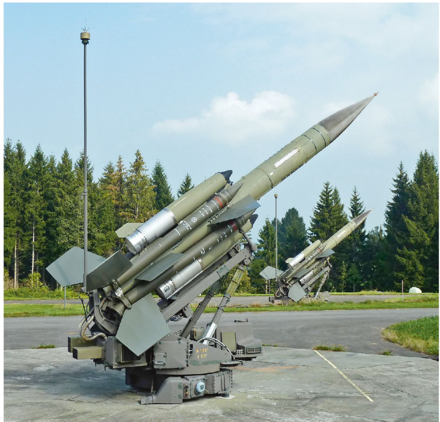
Lenkwaffe auf Werfer. Die Lenkwaffe: 4 Startraketen und 2 Marschtriebwerke (oben, unten); 8,3 m Länge, 2,38 t Startgewicht, Reichweite weit über 120 km, Marschgeschwindigkeit Mach 2,5. Bilder: Autor
