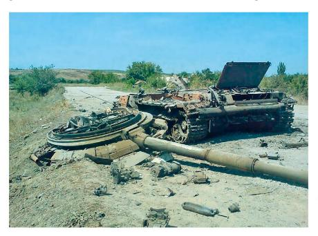
Zerstörter Kampfpanzer T-64BV, man beachte den durch die Explosion der Treibladungen weggeschleuderte Turm des Panzers. Das Raketenrohr RPG-7 kann heute die unterschiedlichsten Gefechtskopftypen verschiessen; diese Waffe ist in allen Krisenregionen verbreitet. Bilder: UKR mil photos
