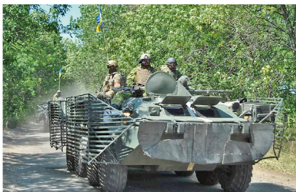
Ukrainische Schützenpanzer BTR, aber auch ältere Panzer T-64 wurden kurzfristig mit seitlicher Slat-Panzerung versehen.
