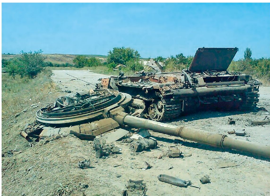
Zerstörter Kampfpanser T-64BV, man beachte den durch die Explosion der Treibladungen weggeschleuderte Turm des Panzers.
