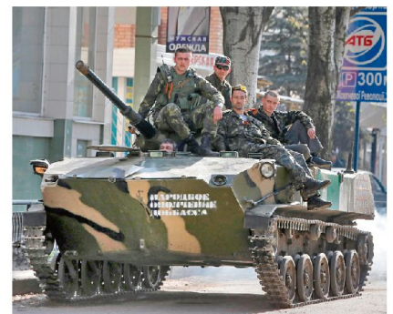
Luftlandepanzer BMD-1 mit Kanone 73 mm.
