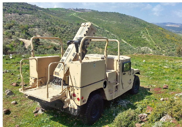
Autonomer leichter Minenwerfer für den Einbau auf leichten Geländefahrzeugen.
