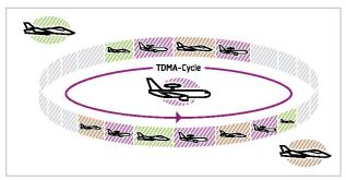
Abb. 2: Time Division Multiplex Access (TDMA): Jeder Slot wird einer Station zum Senden zugeteilt, während die anderen Stationen empfangen. Dies ermöglicht den permanenten Datenaustausch zwischen allen Netzteilnehmern für Commands, Track exchange, Common Operational Picture usw.
