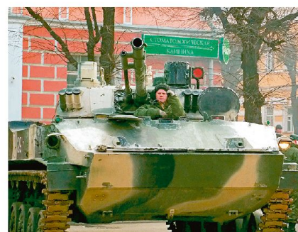
Kampfschützenpanzer BMP-3 mit Kanone 100 mm und rohrparalleler Automatenkanone 30 mm.
