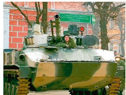
Kampfschützenpanzer BMP-3 mit Kanone 100 mm und rohrparalleler Automatenkanone 30 mm.
