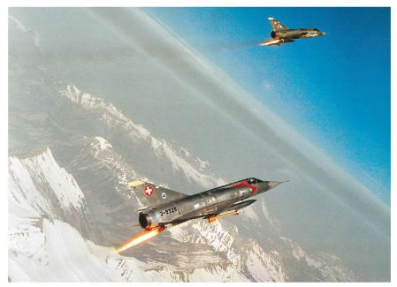
Zwei Mirage IIIS mit Einsatz des SEPR-Triebwerkes.
