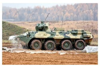
Die Kanone des BTR-82 kann auch gegen Luftziele eingesetzt werden.
