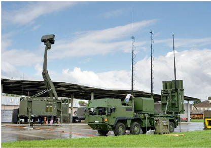
Mögliche Komponenten eines Systems «Mittlere Reichweite»: Super Giraffe AMD und IRIS T-SLM Werfer.
