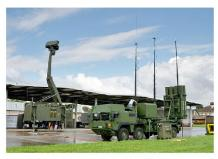
Mögliche Komponenten eines Systems «Mittlere Reichweite»: Super Giraffe AMD und IRIS T-SLM Werfer.
