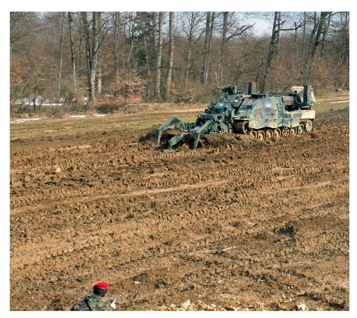
Mit scheinbarer Leichtigkeit und bis zu 15 km/h schnell wird eine Minengasse gepflügt.
