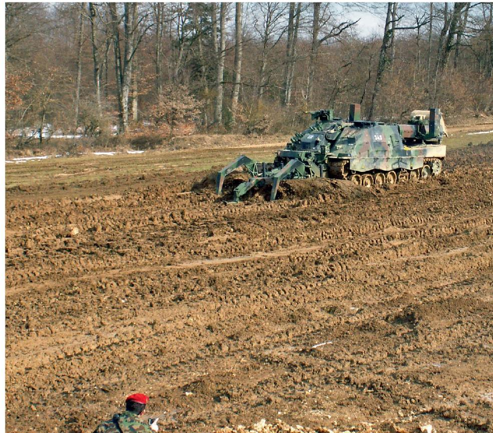
Mit scheinbarer Leichtigkeit und bis zu 15 km/h schnell wird eine Minengasse gepflügt.
