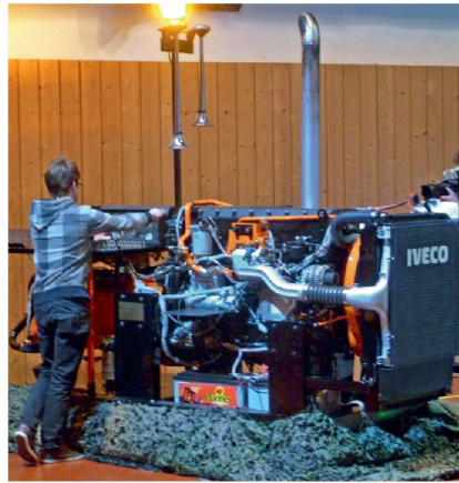
Motor eines Abbruchfahrzeugs + Erfindergeist + Freiwilligenarbeit = Fehlersimulator von Lehrlingen der LBA.
