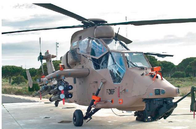
«Tigre HAD» bewaffnet mit Raketenpods und Luft-Boden-Lenk Waffen «Hellfire II». Bild: Armée de Terre
