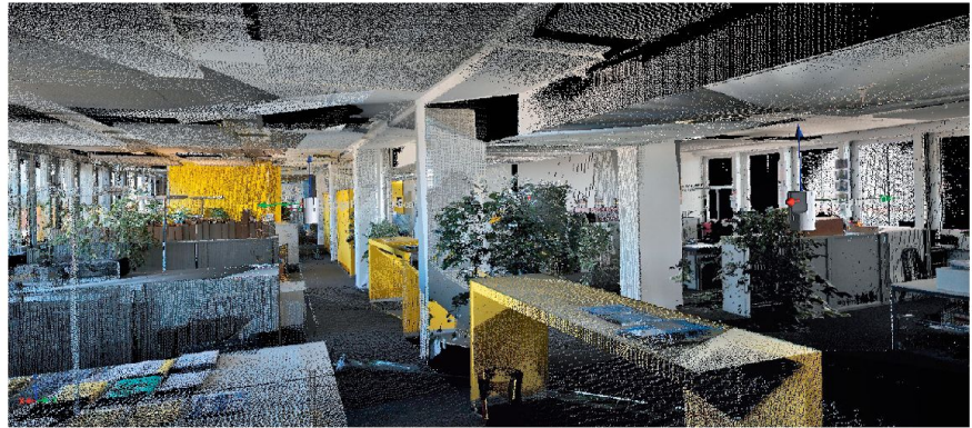
3D-Darstellung des Inneren des armasuisse-Gebäudes W+T in Thun, nachdem ein mit einem robotisierten LiDAR-Scanner ausgestatteter bodengestützter Roboter mehrere Millionen georeferenzierte Punkte vermessen hat (Geosat).
