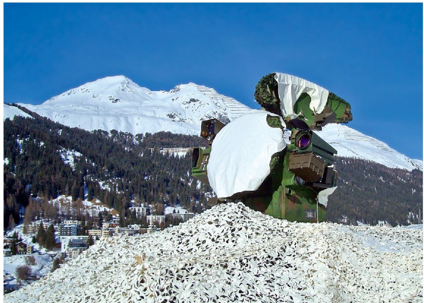
Daten des Folge- und Suchradars sowie Bilder der TV- und IR-Kamera werden live aus dem Einsatzraum in die Einsatzzentrale der Luftwaffe übermittelt.
