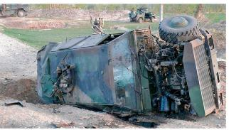
Bedrohung durch Strassenrandbomben in Afghanistan (Dingo nach Explosion einer improvisierten Sprengladung). Bild: Bundeswehr
