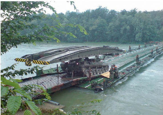
Abb. 2: Panzerbrücke 68/88 auf Schwimmbrücke 95.
