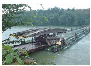
Abb. 2: Panzerbrücke 68/88 auf Schwimmbrücke 95.
