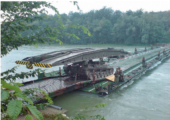
Abb. 2: Panzerbrücke 68/88 auf Schwimmbrücke 95.
