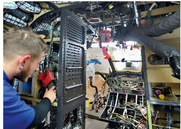
Der verkabelte Super Puma noch ohne Geräte.
