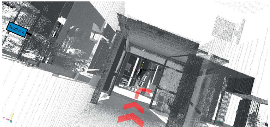
Abb. 5: Informationen, die der Einsatzkraft virtuell eingeblendet werden können: Position weiterer Kräfte oder Routen zu bestimmten Zielen.
