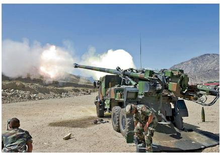
155 mm Selbstfahrgeschütz CAESAR (Camion Equipé d'un Système d'Artillerie).
