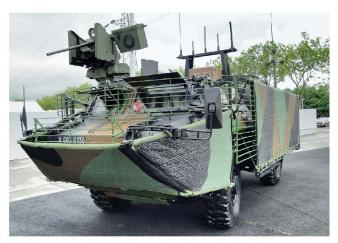
Schützenpanzer «VAB Ultima» mit verbessertem Schutz und fernbedienbarer Waffenstation. Bild: L'Armée de Terre
