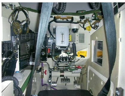
Teilansicht Fahrerkabine FASPA. Nachgebildeter Fahrerplatz des Spz 2000.
