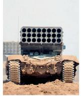
Raketenwerfer «Buratino» auf Fahrgestell Kampfpanzer T-72. Bild: RR mil photo
