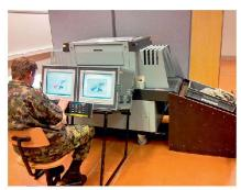
Abb. 3: Werksicherheit – Gepäckröntgenanlage bei der Vorkontrolle (VOKO).
