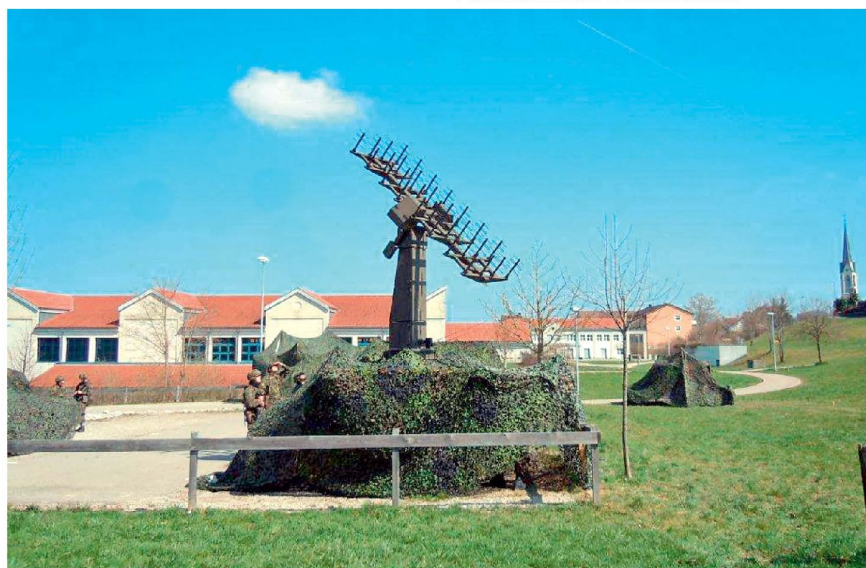
Peilantenne für Wettersonden.
