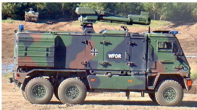
Impulswasserwerfer auf Geländelastwagen «Duro». Bild: Bundeswehr
