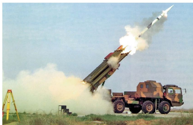
Gelenkte Raketen für den Mehrfachraketenwerfer A200.
