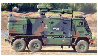
Impulswasserwerfer auf Geländelastwagen «Duro». Bild: Bundeswehr
