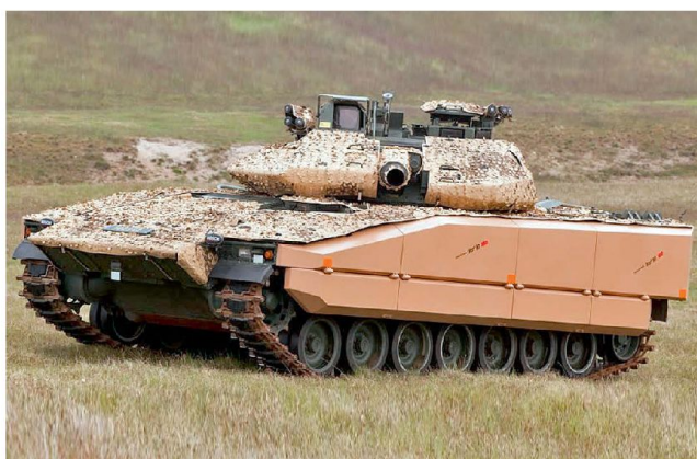
Schwedischer Schützenpanzer CV9040 mit neuem Schutzkonzept.
