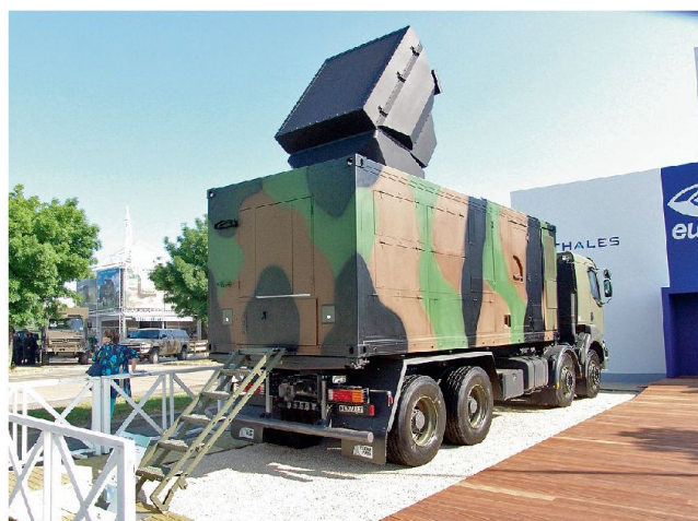
Das Luftabwehrsystem «MAMBA» wird durch Multifunktionsradar «ARABEL» von Thales unterstützt.
