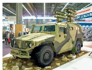
Mehrzwecklenkwaffe «Kornet-EM» auf geschütztem Fahrzeug «Tigr». Bild: Autor
