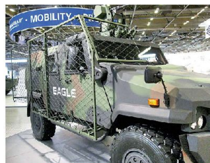
Mehrzweckfahrzeug «Eagle IV» ausgerüstet mit «SidePRO-LASSO». Bild: Eurosatory 2010
