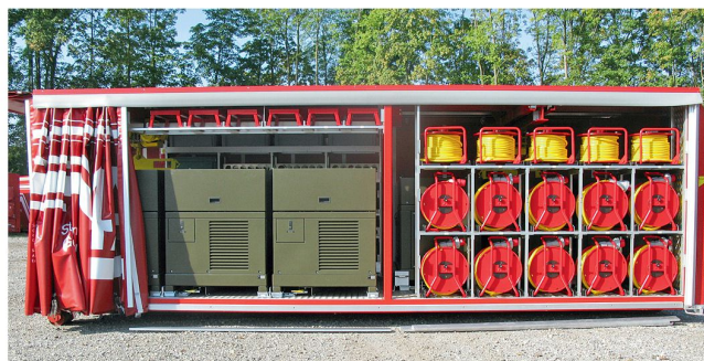
Wechselbehälter mit Stromerzeugung.
