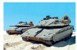
Kampfpanzer «Merkava IV» ausgerüstet mit aktivem Schutzsystem. Bild: Rafael
