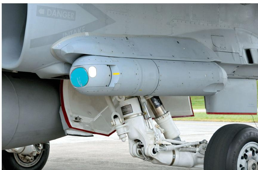
ter mit dem Infrarotsensor wird an einer seitlichen Rumpfstation mitgeführt.
