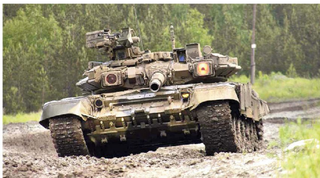
Softkill-System «Shtora» auf dem russischen Kampfpanzer T-90S.
