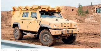
Mehrzweckfahrzeug LMV mit abstandsaktivem Schutzsystem ADS.
