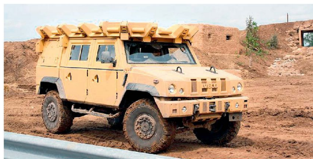
Mehrzweckfahrzeug LMV mit abstandsaktivem Schutzsystem ADS.
