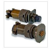
MIL-C-26482, LN29500, VG 95328 und NFC93-422 mod. HE 301. Alle Serien nach diesen Normen sind untereinander steckbar (min. 500 Steckzyklen). Durch die Vielseitigkeit der gesamten Baureihe ist der Einsatz fast überall möglich. Die Features sind: Aluminiumlegierung, leitender olivgrüner Chromatüberzug, Polzahlen von 2- bis 61-polig, Anschlussquerschnitt AWG 16 bis 24, robustes und platzsparendes
