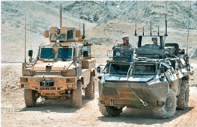
Störsender auf Fz gegen IEDs, links MRAP (USA), rechts VAB (F).
