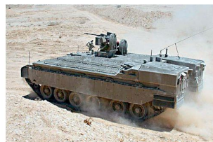
Schützenpanzer «Namer» mit fernbedienbarer Waffenstation.
