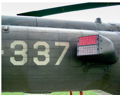
Chaff (Radartäuschziele) und flare (Infrarotäuschziele) Dispenser.
