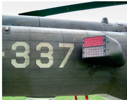
Chaff (Radartäuschziele) und flare (Infrarot-täuschziele) Dispenser.
