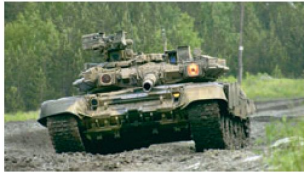
Schutzsystem «Shtora-2» auf Panzer T-90.
