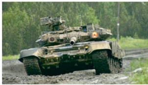
Schutzsystem «Shtora-2» auf Panzer T-90.
