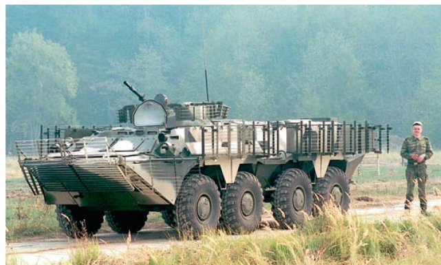
Schützenpanzer BTR-80 mit «Slat Armour».
