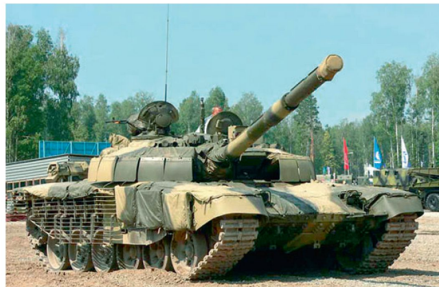
Panzer T-72 mit diversen Schutzverbesserungen.
