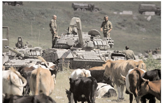
Reaktivpanzerung am Kampfpanzer T-72.
