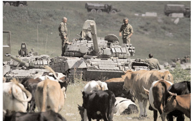
Reaktivpanzerung am Kampfpanzer T-72.
