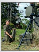
Richtstrahlstation R-905 (im Einsatz bei der FU Br 41 und in den FU-Formationen des Heeres und der Luftwaffe). Bild:FUB
