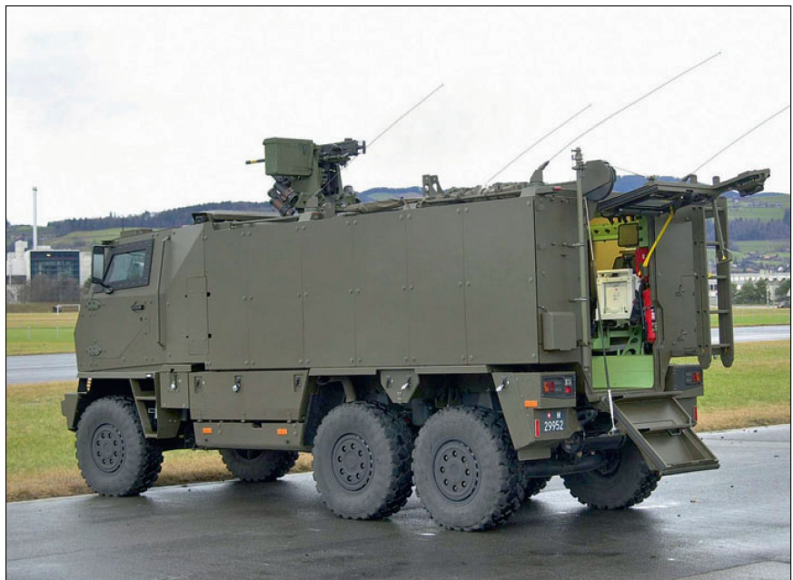
Aussenansicht GMTF mit geöffneter Ausstiegsklappe.
