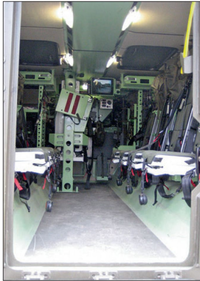
Innenansicht GMTF mit acht Minenschutzsitzen für die Inf Gruppe.
