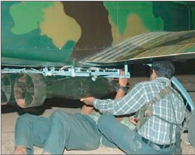
Abb. 1+2: Einfache Aufhängung von Bomben an einer LTTE Zlin-Z143, einem tschechischen Schulungsflugzeug. Bild: TamilNet
