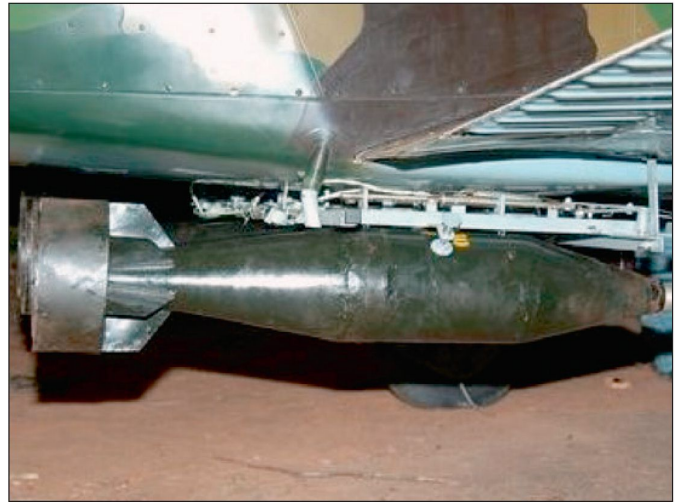
Abb. 1+2: Einfache Aufhängung von Bomben an einer LTTE Zlin-Z143, einem tschechischen Schulungsflugzeug. Bild: TamilNet
