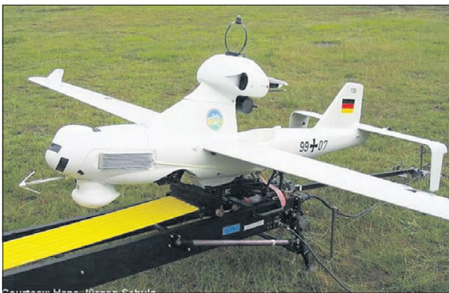
Alle Aufklärungsverbände und -einheiten der Bundeswehr verfügen künftig über unbemannte Luftaufklärungsmittel (Bild: Drohne für die Nahaufklärung «LUNA»).
