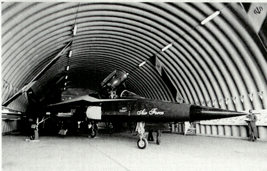
Anlässlich der Truppenparade zum Nationalfeiertag 2007 wurde der Öffentlichkeit erstmals das neue Kampfflugzeug des Typs «Saegheh», eine Eigenentwicklung, gezeigt. Diese ähnelt vorne stark dem F-5, das Seitenleitwerk dem F/A-18.
