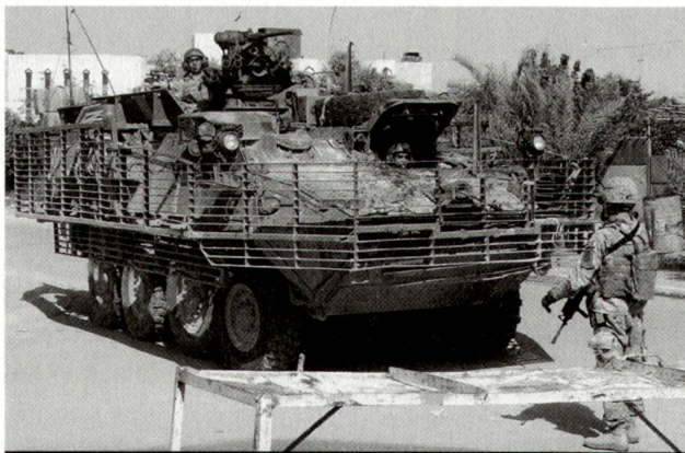
Stryker-Gefechtsfahrzeug im Irak mit «Käfig», der Hohlladungsgeschosse vorzeitig zur Explosion bringen soll.
