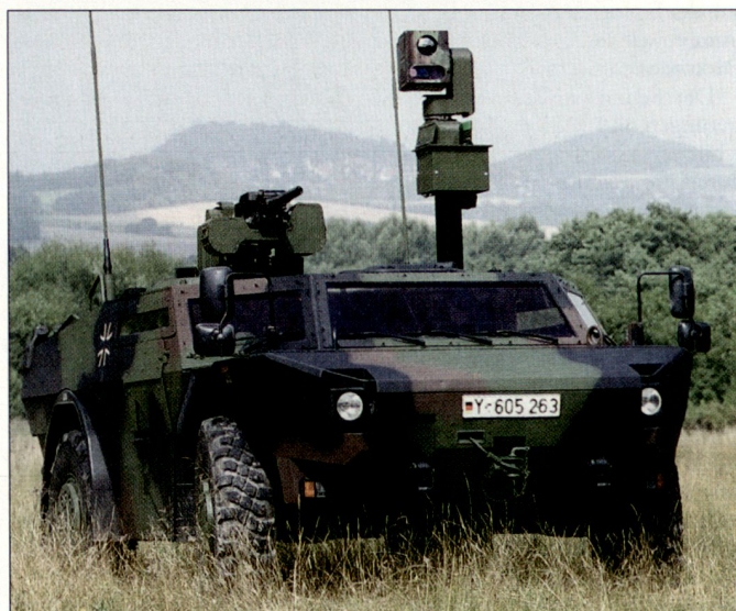
Der Granatwerfer 40 mm wird auch als Bewaffnung des Spähpanzers «Fennek» verwendet.
