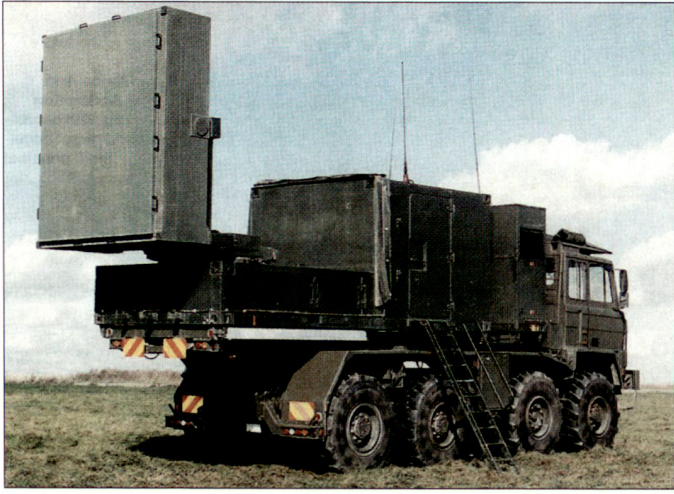
Radarsysteme «Cobra» werden auch zur Verteidigung gegen Mörserangriffe genutzt.
