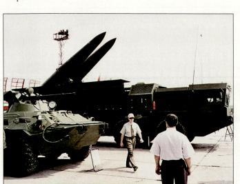
Das Werferfahrzeug des Lenkwaffensystems «Iskander-M» ist mit zwei Raketen bestückt.
