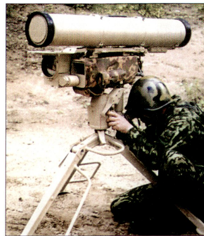
PAL-System «Kornet-E» in Feuerposition. Neben der Lenkvorrichtung ist ein Wärmebildgerät integriert. hg
