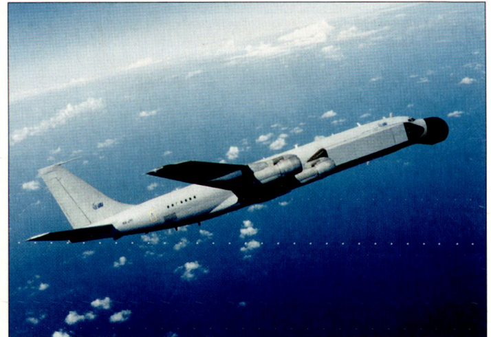
Israel hat u. a. auch luftgestützte Überwachungsradars vom Typ «Phalcon» an Indien geliefert (Bild: israelische Version, eingebaut in einer Boeing 707).
