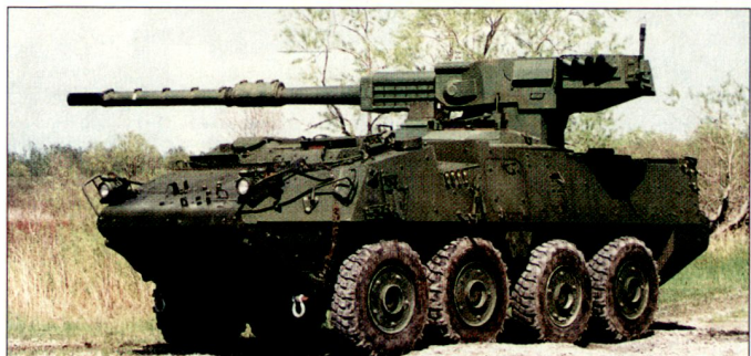
Geschützvariante MGS der neuen gepanzerten Fahrzeugfamilie «Stryker».
