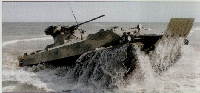
Modernisierte Version MT-LB 6MB mit Kanone 30 mm.
