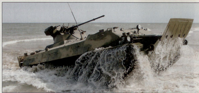
Modernisierte Version MT-LB 6MB mit Kanone 30 mm.
