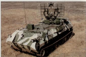
Mobiles Überwachungsradar auf Trägerfahrzeug MT-LB.
