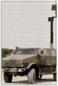
Projekt für ein Boden- resp. Gefechtsfeldüberwachungsradar auf dem geschützten Mehrzweckfahrzeug «Dingo 2».
