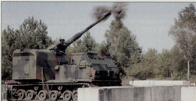
Das neue Artilleriegeschütz 155 mm AGM soll künftig die Feuerunterstützung bei Auslandseinsätzen der Bundeswehr gewährleisten.
